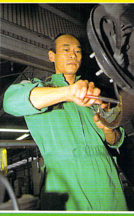
ブレーキシューの交換はメンテナンスの基本。しかし、ブレーキは人の命にかかわる部分だけに、決して気は抜けない。前後のブレーキバランスを取りながら、細かくセッティングしていく。
