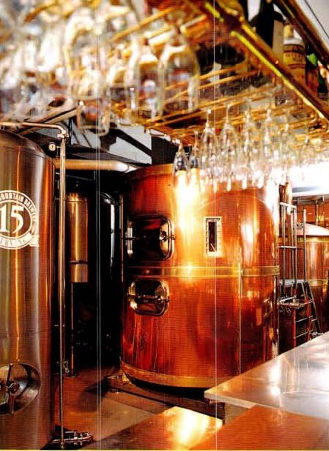
醸造方法を簡単に紹介しよう。まずはモルト（麦芽）を粉碎、お湯を入れて糖化させる。この工程によって出来た麥汁を絞り、冷やしながら酵母をくわえます。ここで約2週間かけ発酵させ、ろ過して完成。リカーマウンテンのブリュワリーには合計14個のタンクを設置して生産ラインを構築している。
