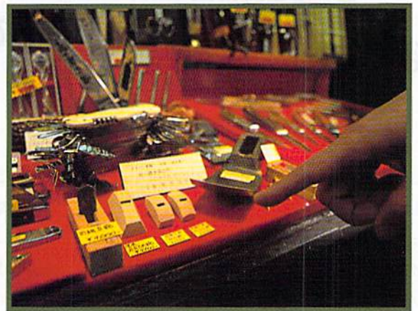
京都にはまだ宮大工が多いことから刃物の種類は豊富にしておく必要があるのだとか。それにしてもこの小さいカンナはどうだ / 微妙な曲線を出す時の必需品である。
