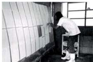
煮いた和紙を乾かす作業は、ボイラーで温められている鉄板で行なう。板に貼りつけて天日干しすることもあるが、最近では和紙の厚さや大きさによって温度を調整できる鉄板の方が好んで使用されるのだとか
