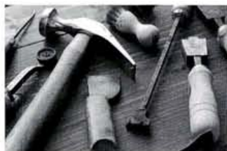
靴底を叩く金槌や、刻印用のコテ、ギザギザ模様をつけるための道具など、どれも靴づくりに欠かせないものばかり。また、他ではなかなかお目にかかれないマニア垂涎の貴重な革も揃えている
