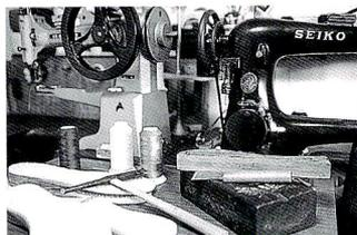
裁断用の包丁、踵部分を固定するために使うトンカチ、ソールのアールを出すためのポン台、製靴用の腕ミシン、修理用の八方ミシンなど、どれも靴をつくるためには欠かせない道具。中でも年代モノのミシンはふたりの愛機
