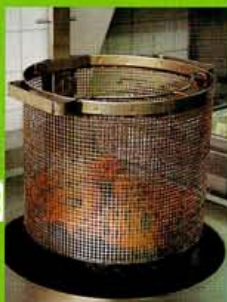
所定の時間になると自動的に油 からあげるシステム。味を完全 に均一にするためだ
