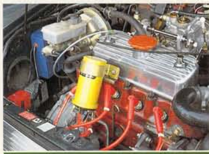
走りを楽しむため20万円もするイタリア製ウェバーのキャブレターに、フルトランススタール・キッド搭載のクラシックにチューンされたエンジン・ルーム内。
